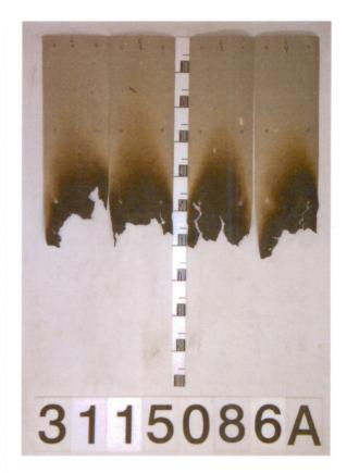
Schädigung der Brandschachtproben: Probekörper A;
